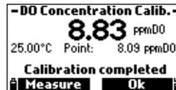
14. Pulse **OK** para volver al menú de calibración o **Medir** para volver a la pantalla de medición.
