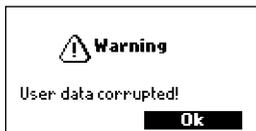
Al encender el medidor, se muestra el mensaje «¡Datos de usuario corruptos!» y los datos de usuario almacenados en el medidor están corruptos.
