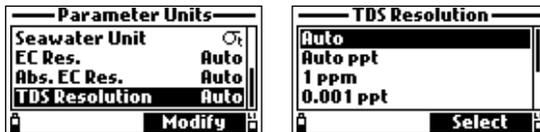
**Auto** El medidor elige automáticamente el rango (ppm o ppt) para optimizar la medición.
