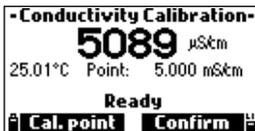
13. Pulse **Confirmar** para guardar la calibración. Se mostrará el mensaje "Almacenando" seguido de "Calibración Completada".
