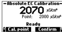
11. Pulse **Confirmar** para guardar la calibración.
