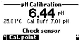
Presione **Borrar** para cancelar los datos antiguos y continuar con el procedimiento de calibración. Alternativamente, presione la tecla **ESC** para salir del modo de calibración de pH.
