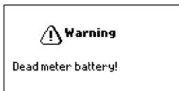
Si las pilas del medidor están demasiado bajas para alimentarlo, se mostrará el mensaje «¡Pilas del medidor agotadas!». El medidor se apagará automáticamente.
