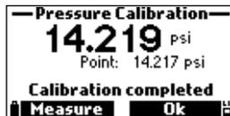
9. Pulse OK para volver al menú de calibración o Medir para volver a la pantalla de medición.
