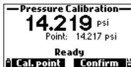
8. Después de la confirmación, se mostrará el mensaje "Almacenando" seguido de "Calibración Completada".
