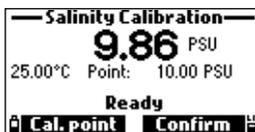
11. Pulse **Confirmar** para guardar la calibración. Aparecerá el mensaje "Almacenando" seguido de "Calibración Completada".
