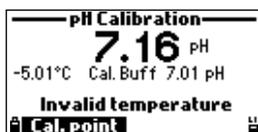
Se muestra "Temperatura no Válida" cuando la temperatura del estándar está fuera del rango aceptable.
