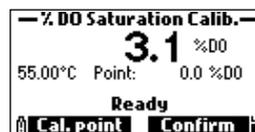
**Notas:** Para guardar una calibración, presione la tecla ESC después de confirmar el estándar.
