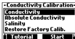
**Nota:** Durante la calibración se debe utilizar el protector de la sonda o el vaso de calibración. Cuando se calibra la conductividad, también se calibran la Conductividad Absoluta y la Salinidad (y viceversa). Se recomienda calibrar la conductividad.
