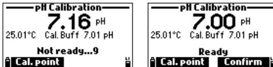
14. Una vez confirmado el punto de calibración, para evitar la contaminación cruzada, vacíe y enjuague el vaso de calibración.
