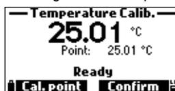
9. Pulse **Confirmar** para almacenar el punto de calibración. Aparecerá el mensaje "Almacenando" seguido de "Calibración Completada".
