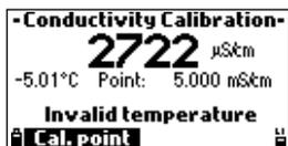
"Temperatura no válida" se muestra cuando la entrada de temperatura no está dentro del rango aceptable (0 a 50 °C).
