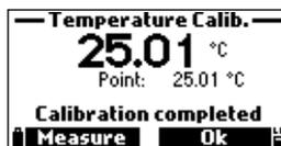
10. Pulse **OK** para volver al menú de calibración o **Medir** para volver a la pantalla de medición.
