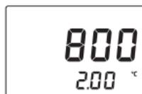
2. Mientras continúa presionando la tecla ON/OFF, presione la tecla ZERO. El La unidad de temperatura cambiará de °C a °F o viceversa.
