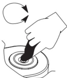
2. Usando una pipeta de plástico, gotee la muestra sobre la superficie del prisma. Llenar el pozo completamente.
