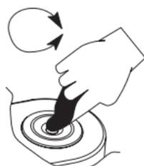
Presione la tecla RANGE para seleccionar las unidades de medida. Cada vez que se presiona la tecla y la pantalla principal indica "nd" para índice de refracción, "nd20" para índice de refracción compensado por temperatura y "bri" para %Brix, cuando el instrumento muestra la pantalla con 4 guiones estará listo para la medición.
