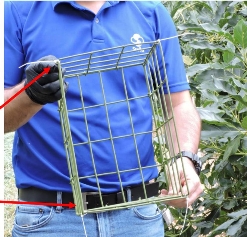
Se debe armar la celda, colocando amarras plásticas en los extremos superiores de la celda.
