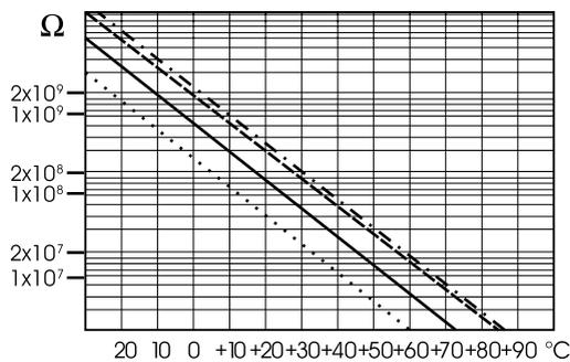
Ya que la resistencia de los electrodos de pH está en un rango de 50 - 200 MΩ, la corriente que recorre la membrana está en el rango de pico amperios. Cantidades grandes de corriente pueden alterar el electrodo por varias horas.
