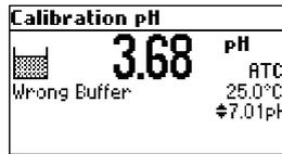
Las lecturas de pH no están dentro del rango del buffer seleccionado. Seleccione otro buffer usando las teclas ▲/▼ o cambie el buffer.
