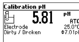
El offset del electrodo no puede aceptar el rango. Revise si el electrodo no está roto o límpiolo siguiendo el procedimiento de limpieza (ver página 45). Revise la calidad del buffer. Si es necesario, cambie el buffer.
