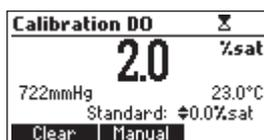
Se abre la pantalla de calibración de O.D. y se selecciona automáticamente el patrón de 0 % de saturación (o 0 mg/L, dependiendo de la unidad de medición que esté seleccionada).
