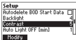
Use las teclas ←/→ para cambiar la intensidad y pulse **Accept** para confirmar.
