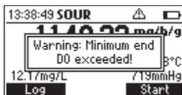
Pulse **LOG** para almacenar todos los detalles de la prueba de SOUR.
