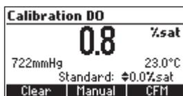
Pulse **ESC** para salir de la calibración o continúe para obtener una calibración de dos puntos.
