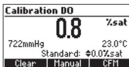
Pulse **CFM** para confirmar el punto de calibración.
