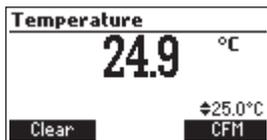
Para eliminar la calibración de temperatura del usuario en cualquier momento, pulse **CAL** desde cualquier modo de medición (DO, BOD, OUR o SOUR). Se abre el menú de calibración. Pulse la tecla de función **Temp** y, a continuación, pulse **Clear**. Se eliminará la calibración de usuario previa y se recuperará la calibración de fábrica.
