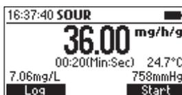
Para analizar otra muestra, limpie y seque la sonda. Coloque la sonda en la siguiente muestra preparada. Pulse **Start**.
