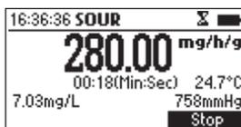
Al finalizar el análisis, el medidor mostrará el valor de SOUR obtenido, la duración de la medición y los valores de presión y temperatura. Pulse **Log** guardar un registro de este análisis.
