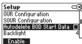
Pulse la tecla de función que se muestra en pantalla para activar o desactivar esta función.
