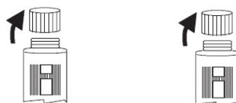
Añada 2.0 mL de agua desionizada al primer vial (#1) y 2mL de muestra al Segundo vial (#2), esto mientras mantiene los viales en un Angulo de 45°. Coloque la tapa e invierta varias veces para mezclar.
