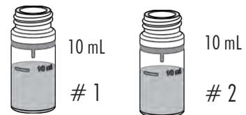
*Nota: Para resultados más adecuados use dos pipetas graduadas para agregar 8 mL de agua desionizada y 8 mL de la muestra.*
