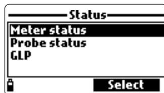
**Nota** Se guardan los datos GLP de las cinco últimas calibraciones. Gracias a este historial de calibraciones, el usuario puede detectar cuándo empiezan a cambiar las lecturas y es necesario limpiar o cambiar los sensores.
