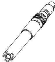
HI 7609829-11: El ISE de cloruros es un sensor combinado de membrana en estado sólido utilizado para detectar iones de cloruro libre en muestras de agua dulce. El sensor utiliza un pellet de cloruro de plata alojado en un cabezal de PEI y un electrodo de referencia de plata/cloruro de plata con unión doble con electrolito gel. Este sensor se utiliza en lugar del sensor de pH de la sonda.
