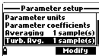
Al igual que ocurre con otras mediciones, el promedio es útil para obtener lecturas representativas del valor "medio" de una corriente de agua. Dado que las burbujas y detritos del flujo de agua afectan más el sensor de turbidez óptico que a cualquier otro sensor, el promedio de turbidez puede configurarse por separado. Pulse <Modificar> para introducir el número de muestras que desea promediar. Puede elegir entre 1 y 20 muestras. El valor predeterminado es 1.
