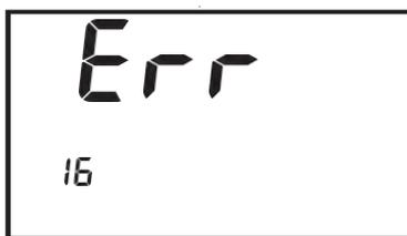
El "Err" que se muestra en la pantalla, seguido del código interno del error. Esta pantalla evitará el acceso a otras pantallas.
