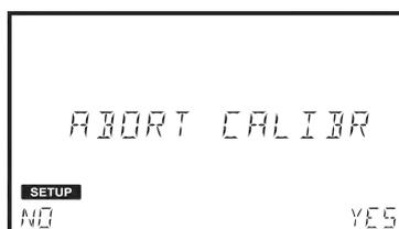
Presione NO para volver a la pantalla del último punto de calibración o presione YES para salir de la calibración.
