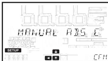
Presione la tecla CFM para iniciar la calibración.
