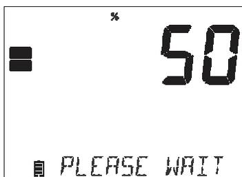
"PLEASE WAIT" y el porcentaje borrado parpadeara hasta que esté completado. El procedimiento se puede repetir para los otros modos de medición.
