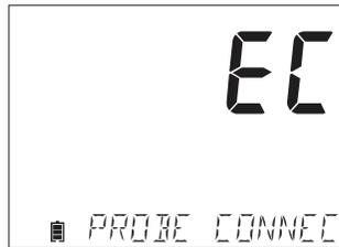
Conecte la sonda de conductividad al instrumento y espere hasta que se carguen los parámetros de la sonda. El siguiente mensaje es desplegado luego en la pantalla LCD: "Probe Connected (sonda conectada)"
