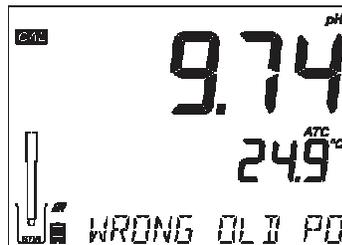
Presione CAL luego presione CLR. Sera desplegada "CLEAR CALIBRATION". Presione CAL para salir de calibración si desea mantener los datos de calibración antiguos en lugar de compensación.
