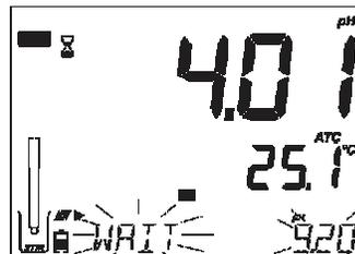
Nota: El valor del buffer personalizado puede ser ajustado en una ventana de pH  $\pm 1.00$  alrededor del valor ajustado durante la calibración. Cuando se visualiza un buffer personalizado, es desplegado el símbolo "C1" o "C2".
