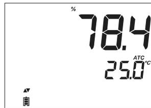
El valor del Oxígeno Disuelto (en) es desplegado en la 1ª línea del LCD y la temperatura en la pantalla LCD secundaria.
