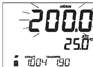
Si la lectura está fuera del rango cuando el rango es automático, será desplegado parpadeando el valor de la escala total (200,0 mS/cm para modo ATC o 500,0 mS/cm para conductividad absoluta).
