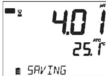
Después de confirmar puntos de la última calibración de búfer deseado, pulse CAL o si todos los valores de cinco tampón se calibraron el instrumento mostrará automáticamente "SAVING", que almacena información y luego volverá al modo de medición normal.
