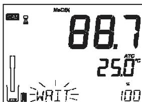
Presione CAL para entrar en calibración. El símbolo "
