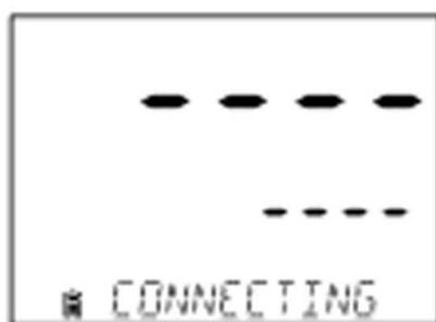
Conecte el conector de la sonda a la entrada de la sonda ubicado en la parte inferior del edge®. Asegúrese que la sonda esté completamente conectada. Si la sonda es reconocida, es desplegado el mensaje "CONNECTING (conectando)".
