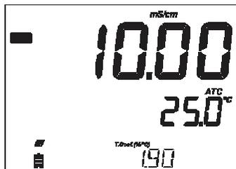
El coeficiente de temperatura en el momento de la calibración junto con la lectura actual.
