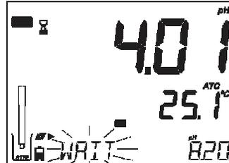
Luego de 5 segundos, se actualiza el valor del buffer. Presione ► si desea cambiarlo nuevamente.
