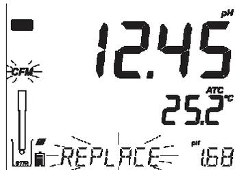
Cada vez que se confirma un buffer, los nuevos datos de calibración reemplazan los datos antiguos para el búfer o cualquiera buffer cercano en una proximidad de  $\pm 0, 2$  pH. Si dispone de buffer actual no almacenados los datos anteriores y la calibración es no completa (cinco buffers), el buffer actual se agrega a la calibración existente. Si la calibración existente está completa, el instrumento le consultara que tampón deberá reemplazar.
