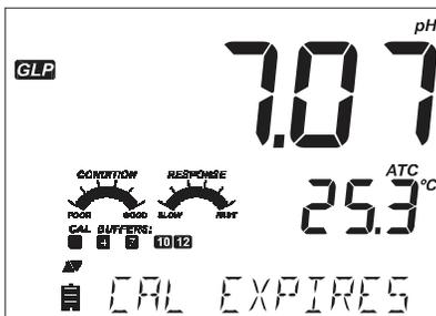
Si utiliza un sensor HI 11311 o HI 12301, la impedancia del cristal es continuamente monitoreada, actualizada y reportada aquí y el indicador de Estado de la Unión es totalmente visible.
