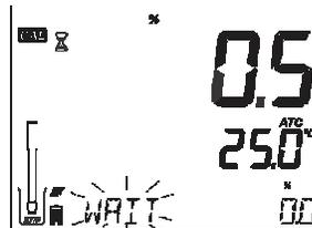
Sumerja el sensor de temperatura y membrana de sonda en el vaso de precipitados que contiene la solución Cero Oxígeno HI 7040 y agite suavemente durante 2-3 minutos. La lectura se apagará.
