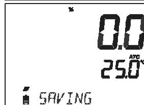
El instrumento desplegará el mensaje "SAVING" y volverá al modo de medición. Enjuague la punta de la sonda en agua antes de tomar mediciones en las muestras.
