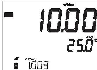
El factor de la celda en cm-1 determinado a partir de la calibración con la lectura actual.
