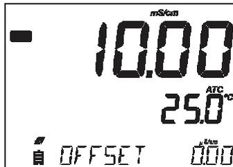
La calibración del factor de compensación en  $\mu\text{Scm}$  junto con la lectura actual.
