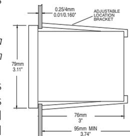
Las abrazaderas ajustables (suministrado con el medidor) permiten al controlador deslizarse en el recorte y sujetará
