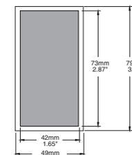
Las dimensiones muestran el corte para la instalación y las dimensiones externas del panel.
