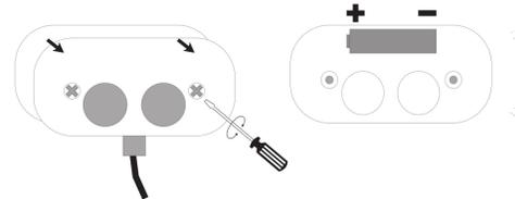
Recoloque la tapa y ate los dos tornillos.
