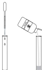
caso, mediante la pipeta de plástico de 1 mL, añada al vial 1 mL de muestra. Llene el vial con agua desmineralizada exactamente hasta la marca de 20 mL. Siga el procedimiento desde el paso 5 al 16 y multiplique el resultado obtenido por 20. El blanco se prepara igual que se ha descrito en el punto 3.
