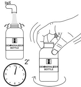
2- Coloque la tapa y agite suavemente durante al menos 2 min. El agua desmineralizada está lista.
