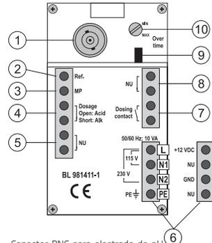
1. Conector BNC para electrodo de pH
