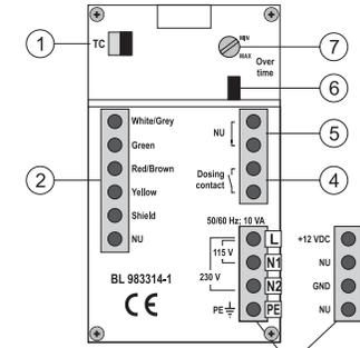
1. Terminal de conexión de sonda, conexiones de baja tensión
