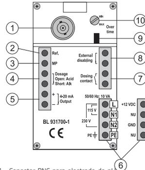
1. Conector BNC para electrodo de pH
