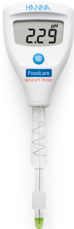
El medidor de pH para vinos HI981033 ha sido diseñado con características avanzadas incluyendo un electrodo de pH único, con una funda móvil de Polietileno (PE) como parte de la unión de referencia externa, y una punta sensitiva en forma de domo fabricada en vidrio de baja temperatura.
