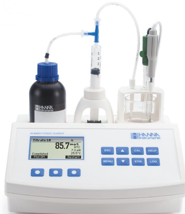
El HI84533 es un mini titulador automático simple, rápido y asequible diseñado para la determinación de número de formol en vinos o jugos de frutas. Este nueva generación de mini titulador automático mejora el sistema de entrega de titulante y rangos de medición para una mayor precisión en comparación con los modelos anteriores. Este medidor refleja los años de experiencia de Hanna como fabricante de instrumentos analíticos.
