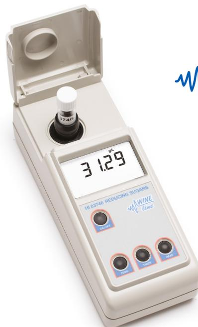
El HI83746 es un Fotómetro para Azúcares Reductores en el vino que combina precisión y facilidad de uso en un diseño ergonómico y portátil. El usuario puede determinar con precisión la concentración de azúcares reductores en el vino dentro de un rango de 0.00 a 50.0 g/L (ppt) usando los reactivos preparados para usar HI83746-20.
