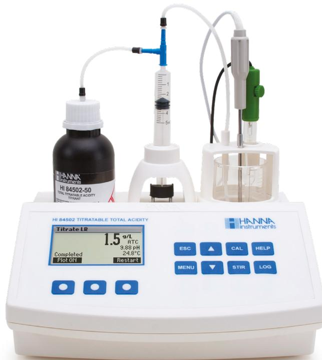
El HI84502 es un mini titulador automático simple, rápido y asequible diseñado para probar los niveles de acidez total en el vino. Basado en un método de titulación ácido-base, este mini titulador utiliza un método de análisis optimizado preprogramado con un poderoso algoritmo que determina el final de la reacción de titulación mediante el uso de un electrodo de pH especializado en vino.
