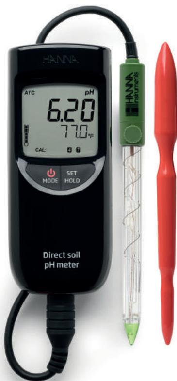
El medidor HI 99121, junto a la sonda pre-amplificada de pH/temperatura HI 12923 permite a los usuarios evaluar tanto el pH del suelo directamente o después de la preparación de una muestra diluida.
