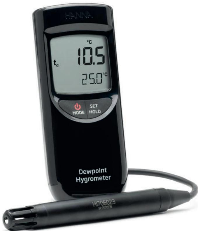
HI 9565 es un termohigrómetro portátil diseñado para proporcionar el máximo rendimiento en entornos difíciles. Para zonas poco iluminadas las HI 9565 presenta una pantalla LCD retroiluminada.
