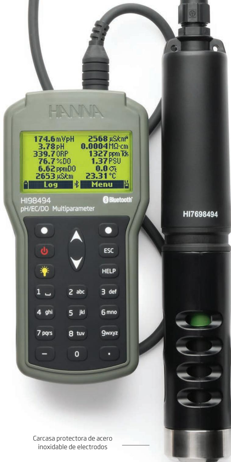
Carcasa protectora de acero inoxidable de electrodos
