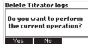
Presione Yes para borrar la lectura o No para volver a la pantalla anterior. Borrar una sola medición causará que se reenumere la lista de registros. Si no hay ningún registro, el mensaje "No records available!" se mostrará en pantalla.
