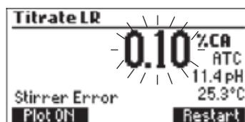
Este mensaje de error aparece cuando el agitador no está funcionando de manera adecuada. Revise el contenido de beaker y la barra agitadora. Presione
