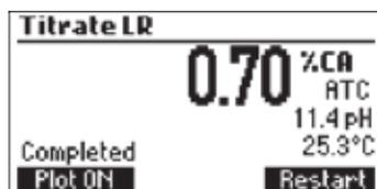
El resultado de la titulación, expresada como %CA %TA o %MA se muestra de manera automática al final de la titulación. Presione Restart para iniciar una nueva titulación o ESC para volver al menú
