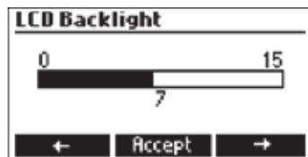
Use las flechas o ← / → para incrementar / disminuir el valor de retroiluminación. Presione Accept para confirmar o ESC para volver a configuración
