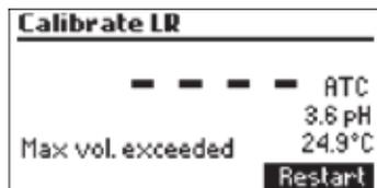
Este mensaje de error aparece durante la calibración de la bomba cuando el punto final no se puede alcanzar y la cantidad máxima de titulante se excede. Revise el titulante, electrodo y/o sistema dosificador y vuelva a intentar.
