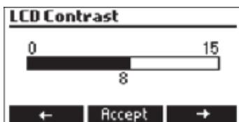
Use las flechas ← / → para incrementar / disminuir el valor. Presione Accept para confirmar el nuevo valor o ESC para volver a configuración.
