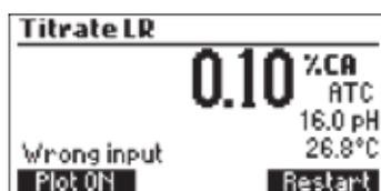
Este mensaje de error aparece cuando las lecturas (pH o temperatura) exceden los límites especificados. El valor de pH o temperatura y la concentración titilará indicando un error.
