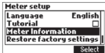
Presione Select para ver la versión del firmware, versión del idioma, fecha y hora de calibración de fábrica para mV y fecha y hora de calibración de fábrica para temperatura.
