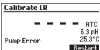
Este mensaje de error aparece cuando la bomba no está funcionando de manera adecuada. Revise el tubo, válvula y jeringa. Presione Restart para intentarlo nuevamente.
