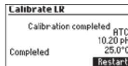
**Nota:** Si la sonda de temperatura no está conectada, se usará la Compensación Manual de Temperatura y la etiqueta MTC aparecerá en la parte derecha de la pantalla. Si se usa la Compensación Automática de Temperatura, la etiqueta ATC aparecerá en la parte derecha de la pantalla.
