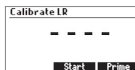
Nota: NO UBIQUE LA PUNTA DISPENSADORA EN EL BEAKER DE CALIBRACIÓN, UBIQUE LA PUNTA SOBRE UN BEAKER DE DESECHOS. UNA PEQUEÑA CANTIDAD DE TITULANTE SE LIBERARÁ CUANDO LA BOMBA SE REINICIE.
