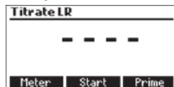
Esta pantalla aparece cuando el titulador está en el modo titulación. Presione Start para iniciar la titulación, Meter para entrar en el modo de medición de pH o Prime para entrar en la función purga.
