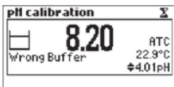
El mensaje "Wrong Buffer" (Buffer erróneo) se muestra cuando el valor de pH está fuera de los valores aceptables. Limpie el electrodo siguiendo el procedimiento de limpieza y/o revise la concentración del buffer antes de continuar con la calibración de pH.
