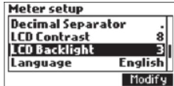
Presione Modify para cambiar el nivel de retroiluminación. El valor predeterminado es 3.
