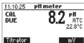
Si CAL DUE se muestra en pantalla debe realizar una calibración del electrodo. Presione MENU para acceder al menú del instrumento.
