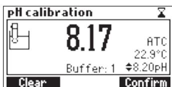
Cuando la lectura se estabiliza, presione Confirm para confirmar la calibración o Clear para restaurar la calibración predeterminada.
