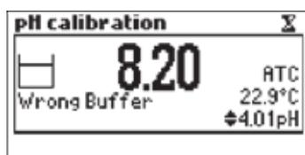
Revise si se está usando buffer correcto o reactive los electrodos de pH siguiendo el procedimiento descrito en el procedimiento de limpieza (ver página 40). Si se requiere, cambie el buffer o el electrodo.
