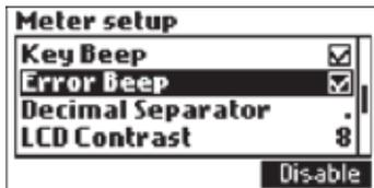
Seleccione Enable para activar o Disable para desactivar la función pitido de error. Si se encuentra activa un pitido se escuchará cuando ocurra un error.
