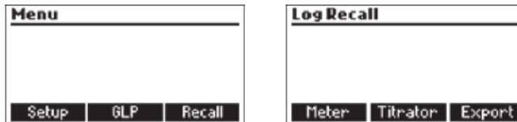
Cuando se conecta un dispositivo USB, la tecla Export aparecerá en pantalla. Esto guardará los registros del medidor y las titulaciones en dos formatos de texto en el dispositivo USB.
