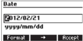
Presione FORMAT para cambiar el ciclo entre los formatos disponibles. Presione → Para resaltar el valor que debe modificar. Use las flechas para seleccionar el valor y presione Accept para confirmar el nuevo valor o ESC para volver a la configuración.
