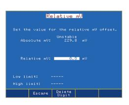
La Calibración Relativa en mV permite un Offset en mV
